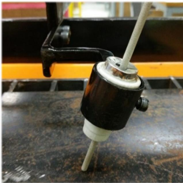
ภาพที่ 3.20 แสดงภาพตัวประกอบลวดเชื่อมหุ้มฟลักซ์ที่มีขนาดของรูแทงลวดเชื่อมที่โตขึ้น
