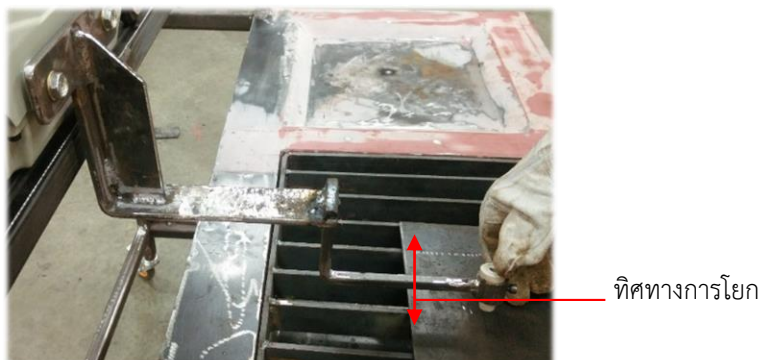
ภาพที่ 3.13 แสดงภาพทิศทางการโยกของตัวประกอบลวดเชื่อมหุ้มฟลักซ์ ตัวประกอบหัวเชื่อมแก๊ส ที่ยึดเข้ากับชุดแขนยื่นจากมอเตอร์ที่ไม่แข็งแรง
